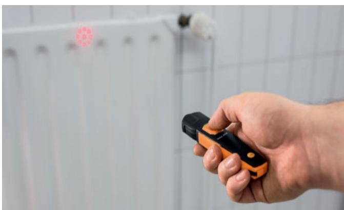
Måling på en malt radiator for kontroll av f. eks. varmehed i innjustering varmesystem
