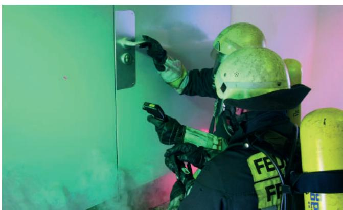
Måling på en malt ståldør for å kontrollere om det er brann eller varme gasser bak
