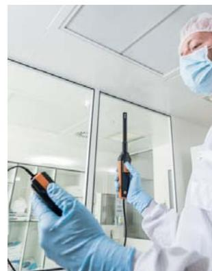
Trenger du å utføre målinger på steder der Bluetooth ikke er mulig? Ikke noe problem: bare bytt målehodet over fra Bluetooth til kabelhåndtaket, og du er klar.
