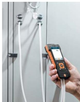
Med testo 440 dP-modellen, inkl. differensialtrykkføler, kan du forsikre deg om at filtrene i klimaanlegget fungerer som de skal, og ingen forurensning i uteluften kommer inn i innelufta.
